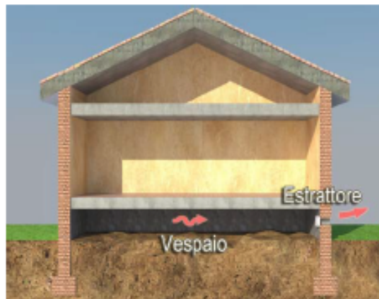
Schema dell'intervento di ventilazione forzata del vespaio.
