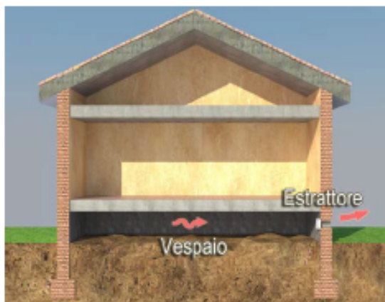
Schema dell'intervento di ventilazione forzata del vespaio.
